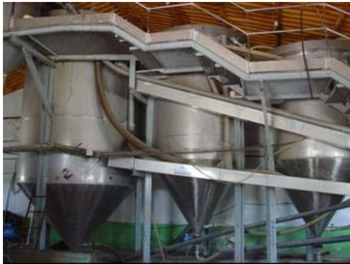
Sedimentadores cilíndricos de base cónica.
