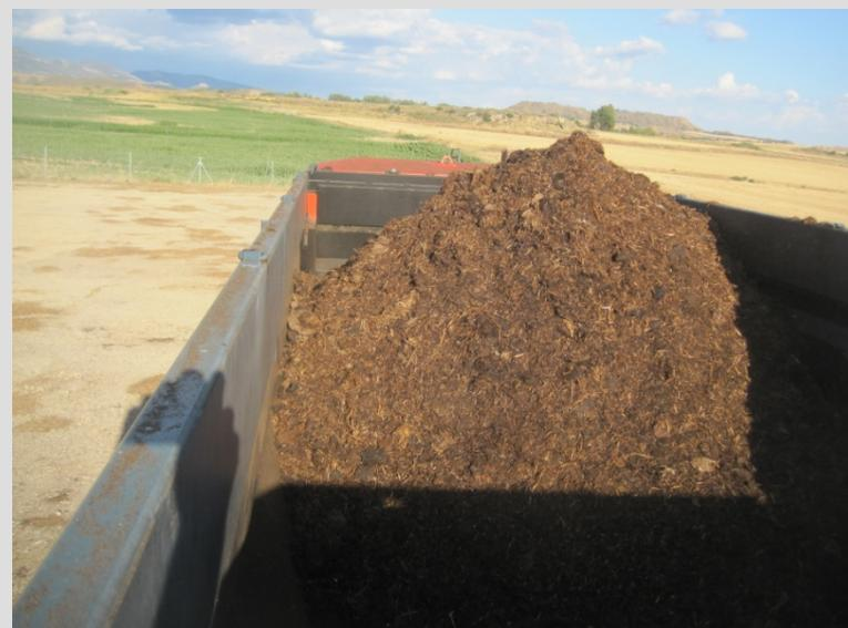
Caja metálica de L x a x h con fondo transportador y compuerta regulable
