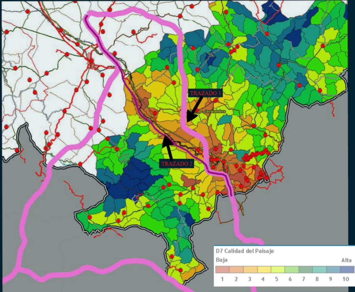
El Mapa de paisaje de la Comarca de Gúdar-Javalambre, sirvió para adoptar la propuesta de modificación del trazado en la colocación de una línea de alta tensión por parte del Ministerio de Fomento (Platea-Godelleta), por el paso de la línea por zonas calificadas de alta calidad de paisaje (**TRAZADO 1**)
