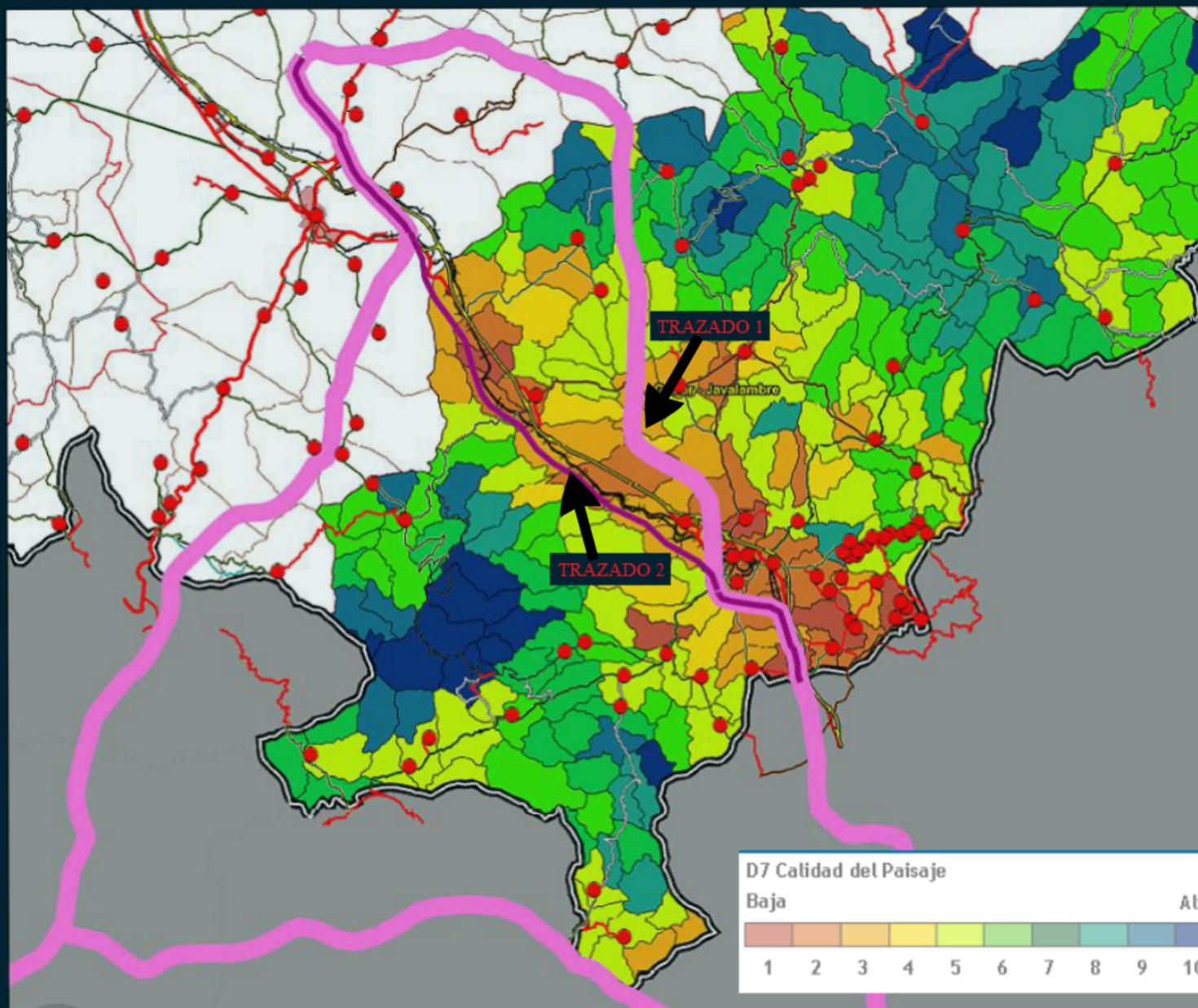
El Mapa de paisaje de la Comarca de Gúdar-Javalambre, sirvió para adoptar la propuesta de modificación del trazado en la colocación de una línea de alta tensión por parte del Ministerio de Fomento (Platea-Godelleta), por el paso de la línea por zonas calificadas de alta calidad de paisaje (**TRAZADO 1**)
