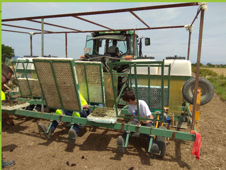
Image 1 . Plantadora de Tomate adaptada. Fuente: Cooperativa San Licer
